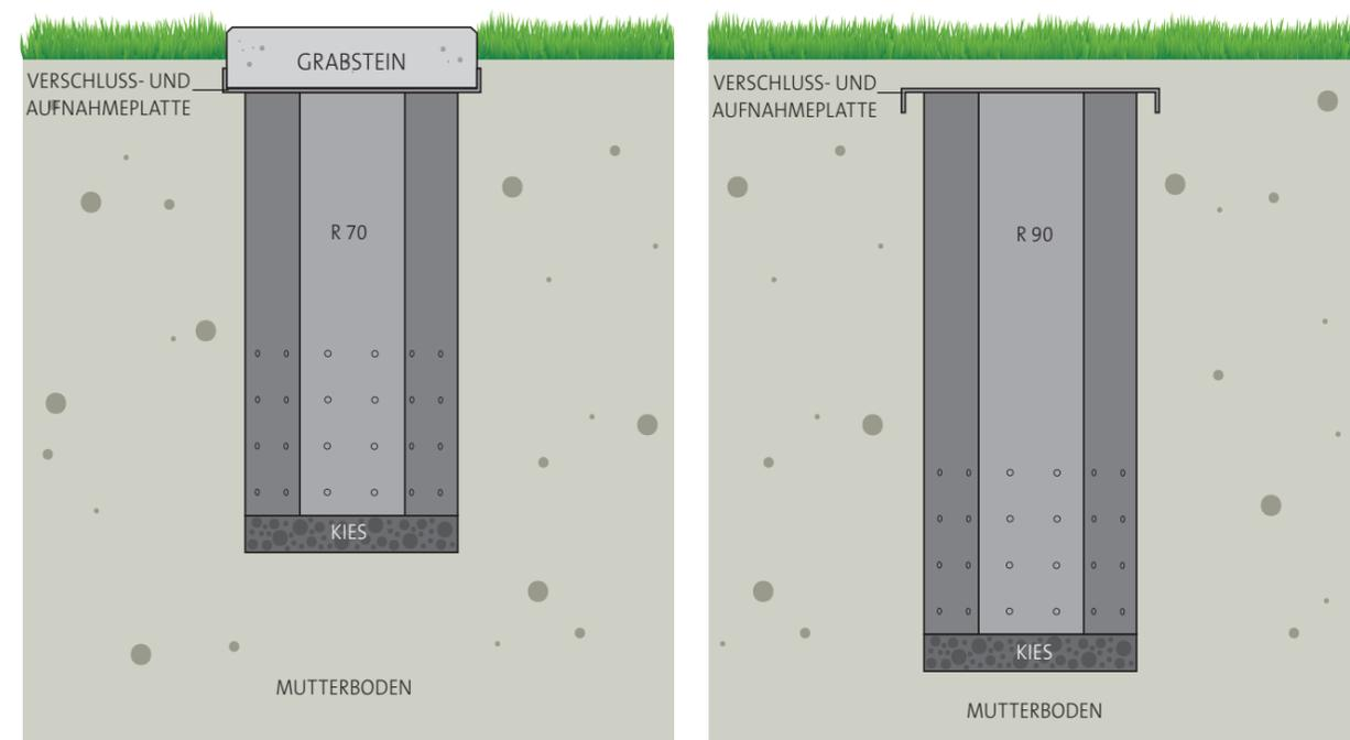
Einbauskitze eines Urnenerdrohres R 70 mit bodengleichem Grabstein
