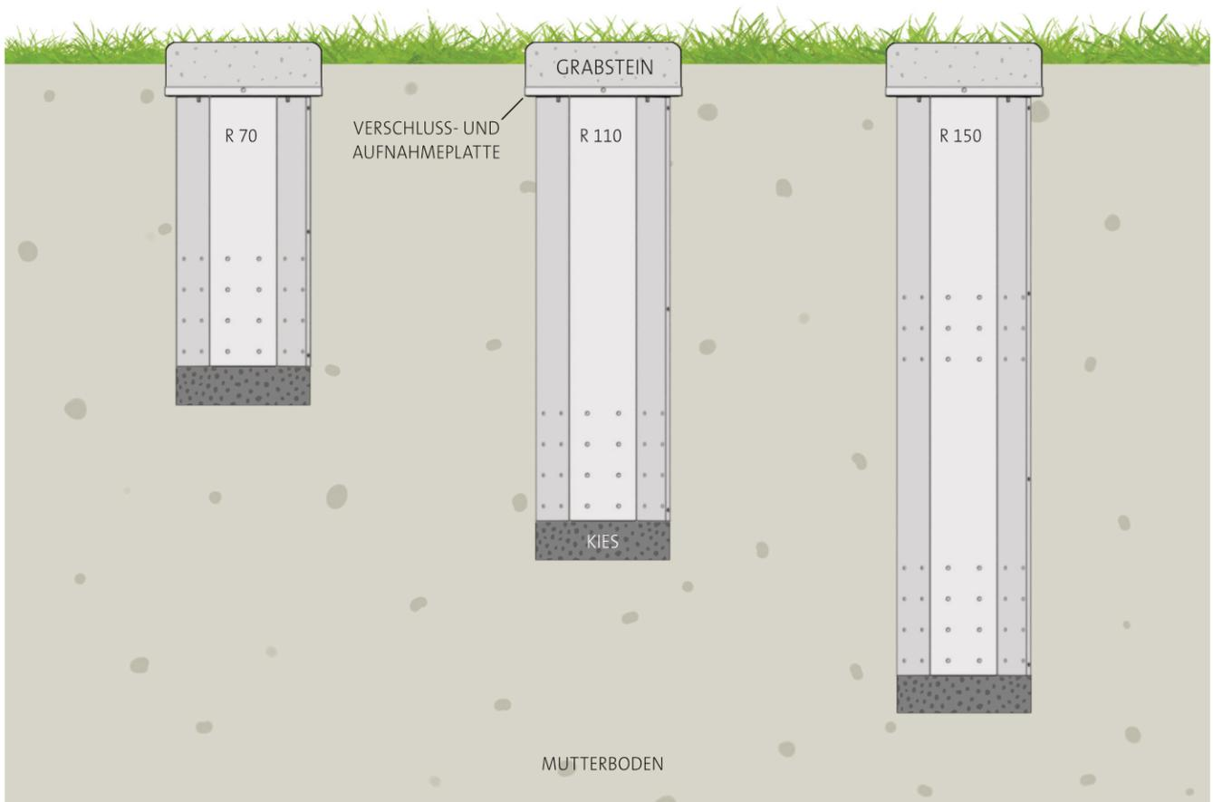
Einbaukizze eines Urnenerdrohres R 70, 110 und 150 mit bodengleichem Grabstein
