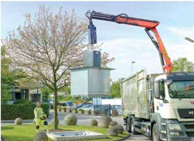
In alleiniger Bedienung kann der Entsorger den unterirdischen Sammelbehälter mit Hilfe eines Krans anheben und aus dem Betonschacht herausziehen. Dabei schließt der Sicherheitsboden automatisch und schützt vor Hineinfallen in die Grube.
