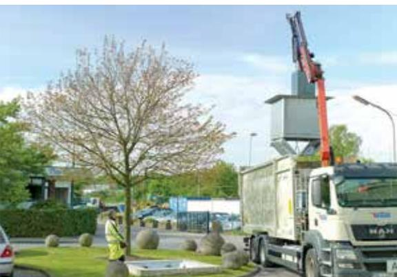
5. Durch Absenken der beweglichen Zugstange werden die Bodenklappen geöffnet und so der Sammelbehälter entleert.
