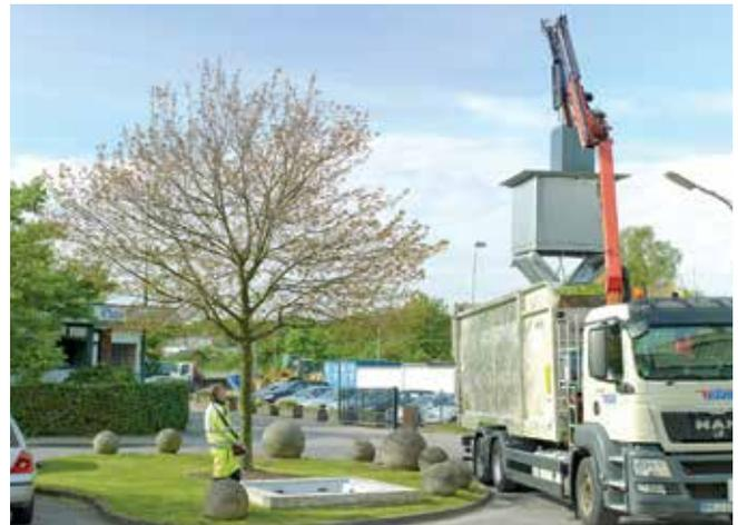
Der Entsorger hebt den Sammelbehälter über sein Fahrzeug und entleert ihn, indem die Bodenklappen geöffnet werden. Dies wird über das Aufnahmesystem gesteuert. Anschließend werden die Bodenklappen geschlossen und der Behälter wieder in den Schacht gesetzt.
