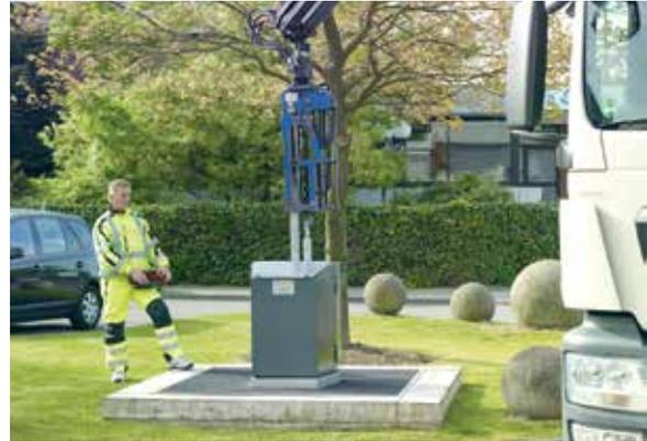
2. Die bewegliche Zugstange wird nun angezogen, Die Bodenklappen bleiben auch bei Anheben des Sammelbehälters geschlossen.
